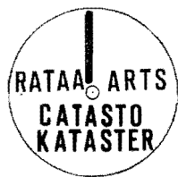
CENTRINO METALLICO DI RIFERIMENTO E DI PROFONDITA' METALLISCHE BEZUGS- UND TIEFENSCHLEIBE
