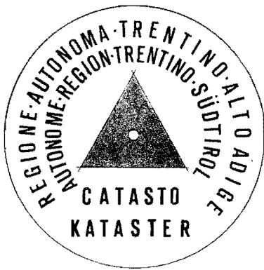
CENTRINO METALLICO DI SUPERFICIE METALLISCHE OBERFLÄCHENSCHLEIBE
